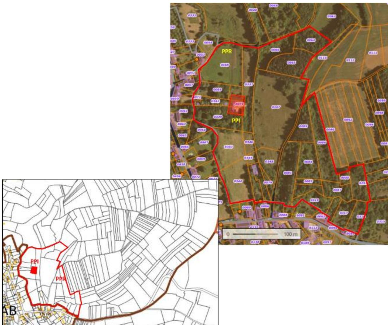
Figure 14 : limites des périmètres de protection immédiate et rapprochée du captage de la source de la Claimpie
